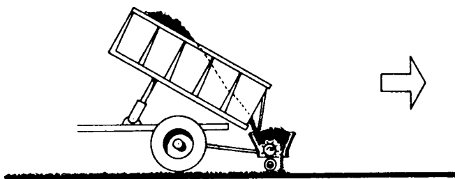
Figura VII-5. Extendedor con tolva (sobre ruedas).
